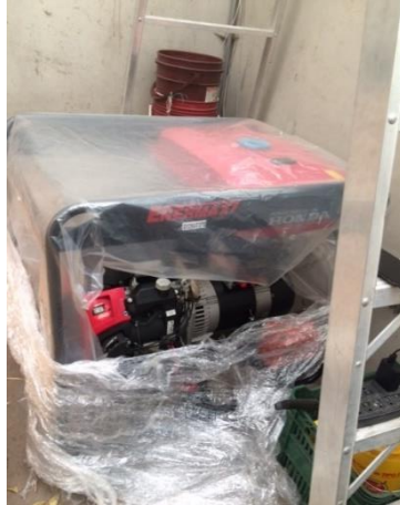
Motor de combustión interna para la generación de energía eléctrica. (5kw/e nominal)
