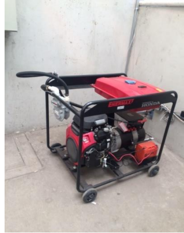
Motor de combustión interna para la generación de energía eléctrica. (5kw/e nominal)
